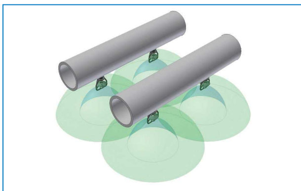
Distribution par pulvérisation de tours de refroidissement à circuit fermé
